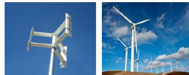
Eoliennes à axe vertical et horizontal
